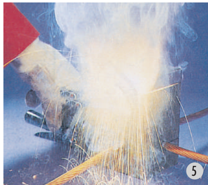
Tepkime kalıbın içinde güvenli biçimde başlar. (Reaction stars safely in the mould.)
